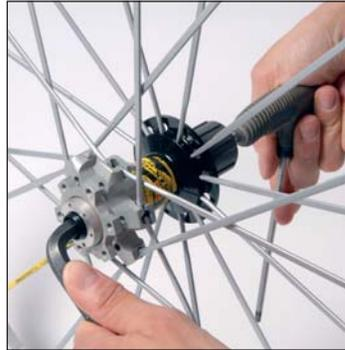
Introduisez la clé 6 pans de 10 mm dans l'axe par le côté opposé roue libre et celle de 5 mm par le côté roue libre et dévissez.
