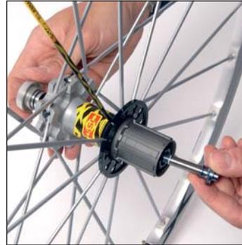
Retirez la vis de bout d'axe côté roue libre puis l'axe côté opposé roue libre.
