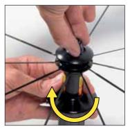
Revissez l'écrou de réglage du moyeu pour maintenir en place les têtes de
