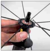
Insérez les têtes de rayon dans les encoches du moyeu côté opposé roue
