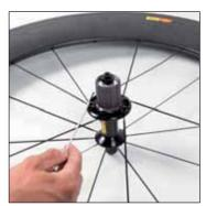
Ce rayon est tracteur : insérez sa tête dans le trou du moyeu correspondant en restant touiours au-dessus des ravons non-tracteurs.
