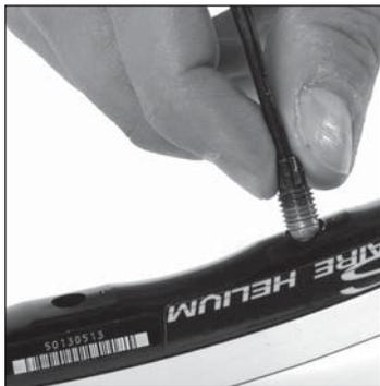
Vissez de 2 tours l'écrou de ce rayon dans le **1er trou à droite du trou de valve** (trou à proximité des coups de pointeau).
