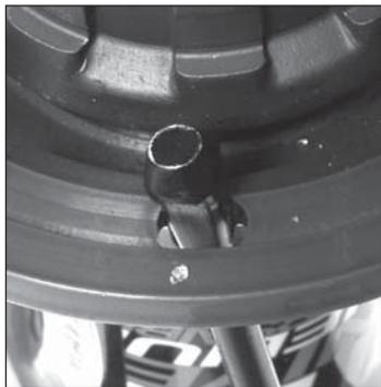
Insérez un rayon 275 mm (324 179 01) dans un perçage du moyeu côté roue libre par l'intérieur du flasque. **Choisissez impérativement un perçage repéré par un coup de pointe.**
