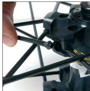
Insérez les têtes de ces rayons dans les créneaux du moyeu côté disque : les rayons non freineurs dans les encoches intérieures, les rayons freineurs dans les encoches extérieures.
