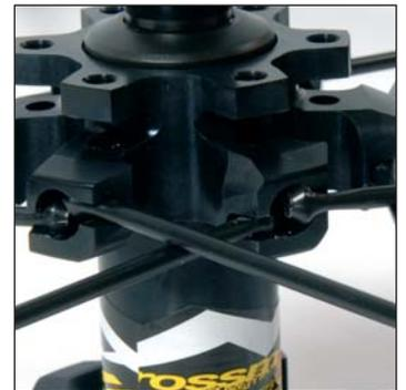
Insérez les têtes de ces rayons dans les créneaux du moyeu côté disque : les rayons non freineurs dans les encoches intérieures, les rayons freineurs dans les encoches extérieures.
