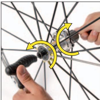
Introduzca una llave allen de 5 mm en cada extremo del eje y desenrosque el extremo del eje del lado del piñón.
