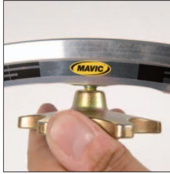
Rosque las cabecillas de radio en la llanta mediante la llave de radios 996 079 01 hasta que ya no se vea fijaroscas.
