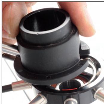
Introduzca la punta del destornillador a través de la rendija del útil para casquillo TraComp en la ranura del casquillo TraComp, entre los dos clips exactamente
