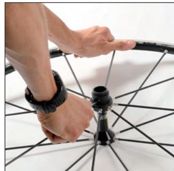
Haga palanca empujando el mango del destornillador hacia abajo, para extraer el casquillo TraComp.
