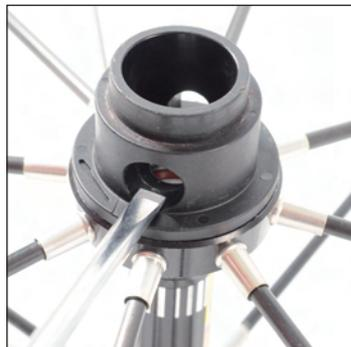
Introduzca la punta plana del destornillador por el orificio del útil para casquillo TraComp.
