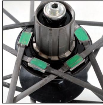
Coloque las plaquetas metálicas en su alojamiento, primero a un lado del buje, después del otro.
