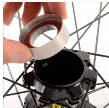
Saque el rodamiento del lado opuesto al disco. Estando el rodamiento insertado en un separador, es posible que este salga junto con el rodamiento. Separe ambos si esto ocurre.
