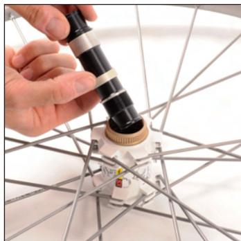
Saque el eje. Con la Crossmax SX, tenga cuidado de no perder la arandela de ajuste del rodamiento que va montada sobre el eje.
