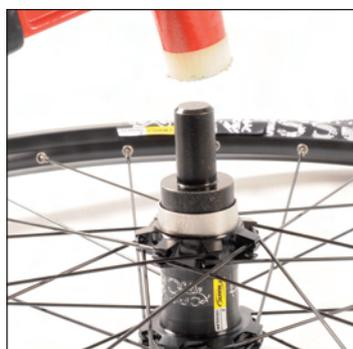
Vuelva a montar ahora el conjunto rodamiento/ separador en el buje por el lado opuesto al disco presionando mediante el útil de montaje M40218.
