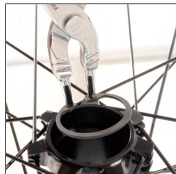
Vuelva a montar el circlip por el lado opuesto al disco mediante el alicata de circlip.
