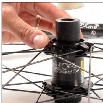
Introduzca el nuevo rodamiento del lado del disco por el lado opuesto al disco y presione mediante el útil de montaje M40218 y un tubo suplementario
