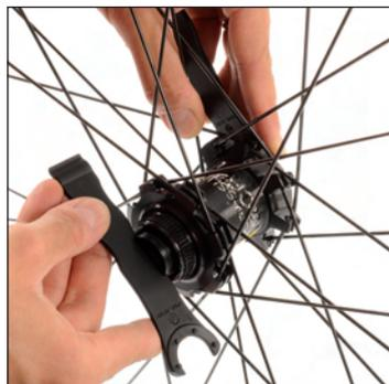
Manteniendo la llave M40123 en su lugar, desenrosque el eje por el lado del disco con los dedos (Crossmax SX) o el mango de una segunda llave M40123 introducida en las ranuras del eje (Crossline).
