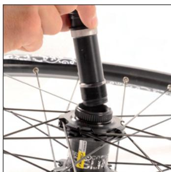
Introduzca el eje en el buje por el lado del disco. En la Crossmax SX 09, tenga cuidado de comprobar que la arandela de ajuste está en su sitio.
