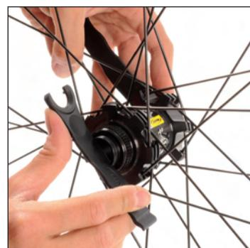
Vuelva a montar la tuerca de ajuste mediante la llave de pitones, manteniendo el eje con la mano (Crossmax SX) o el mango de una segunda llave M40123 introducida en las ranuras del eje (Crossline) hasta contactar con el rodamiento y afloje un 1/4 de vuelta.
