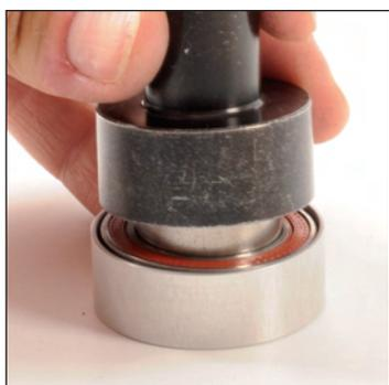
Si durante el desmontaje, el separador del lado opuesto al disco ha salido del buje, empiece por montar el nuevo rodamiento dentro del separador mediante el útil de montaje M40218.
