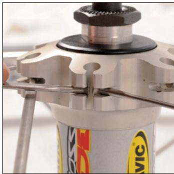
Introduzca la cabeza de un radio en una almena del buje para que este radio sea frenante.
