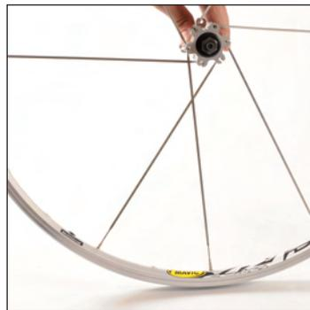
Con el orificio de la válvula junto a usted, introduzca este radio en el tercer agujero a la derecha de la válvula y rosque dos vueltas su cabeza. Haga lo mismo con los otros 6 radios frenantes del lado del disco.
