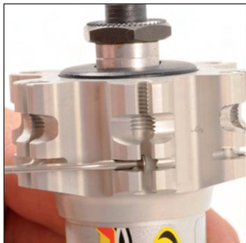
Introduzca la cabeza de un radio en una almena del buje para que este radio sea no frenante.
