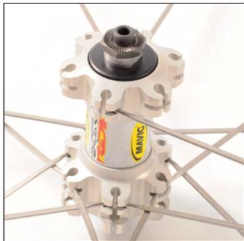
Dé la vuelta a la rueda. Introduzca la cabeza de un radio en una almena del buje para que este radio sea no frenante.
