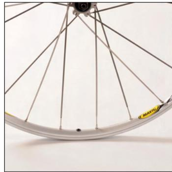
Con el orificio de la válvula junto a usted, introduzca este radio en el primer agujero a la derecha de la válvula y rosque dos vueltas su cabeza. Haga lo mismo con los otros 6 radios frenantes del lado opuesto al disco.
