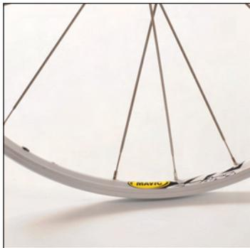
Con el orificio de la válvula junto a usted, introduzca este radio en el tercer agujero a la derecha de la válvula y rosque dos vueltas su cabeza. Haga lo mismo con los otros 6 radios no frenantes del lado opuesto al disco.
