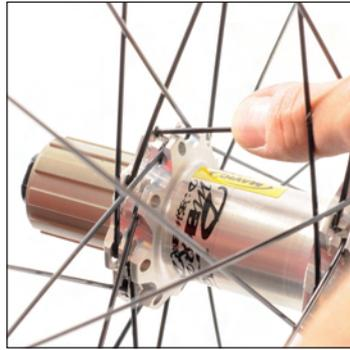
Si el radio se sitúa en una almena exterior, ponga la cabeza de este en la ranura orientándola paralelamente al eje del buje por el interior de la rueda.
