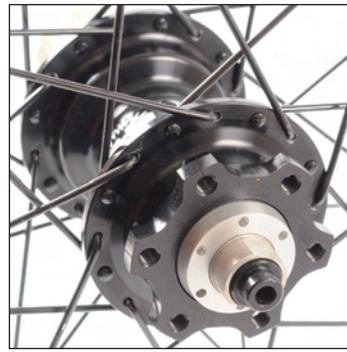
En la rueda trasera, por el lado opuesto al piñón, los codos de los radios tractores deben estar orientados hacia el interior del ala del buje.
