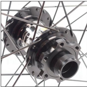
En ambos lados de la rueda delantera los codos de los radios frenantes deben estar orientados hacia el exterior de las alas del buje.
