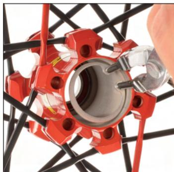
Vuelva a montar el circlip por el lado opuesto al disco mediante el alicate de circlip.
