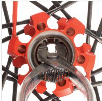
Saque el rodamiento del lado opuesto al disco y quite el circlip por el lado opuesto al disco mediante el alicate de circlip.
