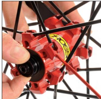
Mantenga la tuerca de ajuste en su lugar mediante la llave M40123 y desenrosque el eje con los dedos por el lado opuesto al disco después saque el eje.
