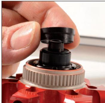
Extraiga el apoyo de horquilla del lado del disco.
