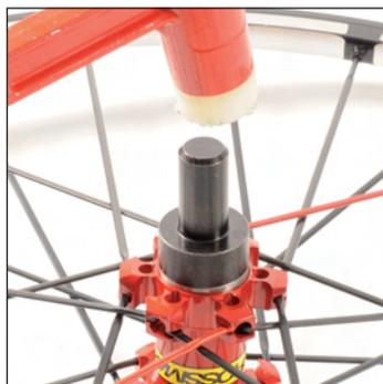
Monte el nuevo rodamiento del lado opuesto al disco mediante el útil de montaje M40218.
