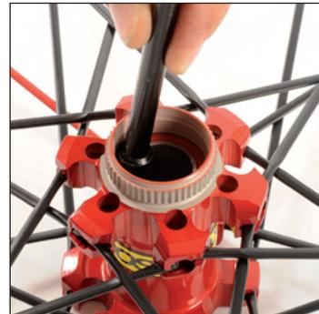
Saque el rodamiento del lado del disco empujándolo mediante el útil de desmontaje por el exterior del buje de forma que el rodamiento salga por el lado opuesto.
