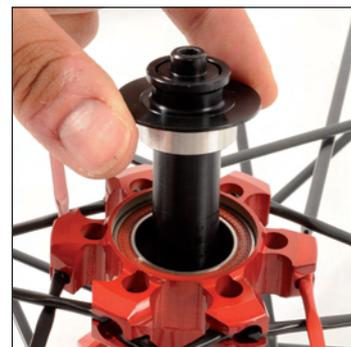
Vuelva a montar el eje en el buje por el lado opuesto al disco, enrosque la tuerca de ajuste mediante la llave de pitones hasta contactar el rodamiento y aflojela un 1/4 de vuelta.
