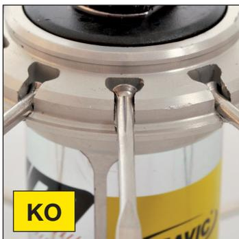
Enrosque cada una de las cabecillas de manera uniforme, (una vuelta de llave a cada radio en cada vuelta completa a la rueda) hasta dar tensión suficiente a la rueda, comprobando que cada cabeza de radio está **perfectamente asentada en su alojamiento en el buje** para prevenir que se pueda salir cualquier radio o incluso la rotura del buje.
