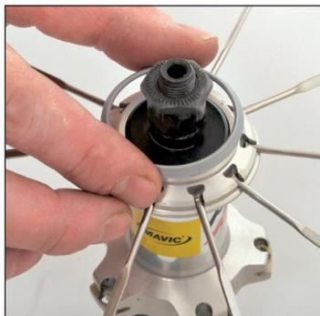
Inserte el guardapolvos en el ala del buje (esto le permitirá mantener los radios en su sitio mientras continua con el montaje).
