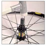
Extraiga el rodamiento por el lado del disco, mediante el útil de desmontaje 108 850 01.
