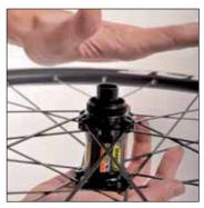
Retire la arandela cónica, la horquilla y la Extraiga el eje por el lado del disco. arandela plana golpeando suavemente sobre el eje por el lado del disco (¡Tenga cuidado de no perder estos 3 elementos!).
