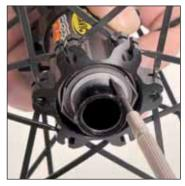
Mediante el alicate para circlips exteriores, vuelva a montar el circlips exterior sobre el eje, por el lado opuesto al disco. Asegúrese del buen posicionamiento del circlips en su alojamiento presionando sobre tres puntos.
