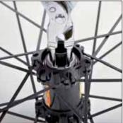
Retire el circlips mediante el alicate para circlips exteriores.
