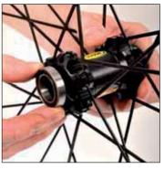
Introduzca el nuevo rodamiento del lado del disco por el lado opuesto a éste y encájelo mediante el útil de montaje 996 887 01.
