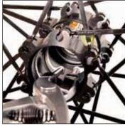
Desde el lado opuesto al disco, vuelva a montar en su alojamiento el segundo circlips interior mediante el alicate para circlips interiores (por el lado del disco) y después haga lo mismo con el primer circlips interior (lado opuesto al disco).
