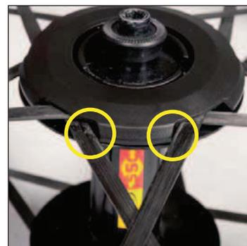
Compruebe que la tapa está bien montada. Atención: la tapa no debe estar en contacto con los radios.
