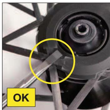
Atención : el destornillador debe estar correctamente situado entre los dos radios y ha de apoyarse en el cuerpo del buje. Un destornillador mal posicionado puede dañar los radios.
