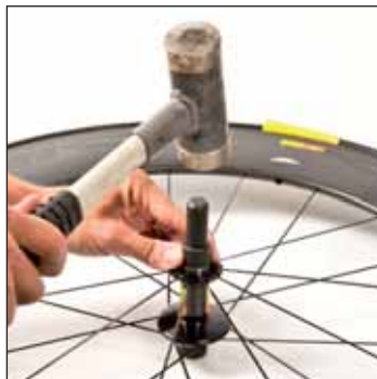
Montar el nuevo rodamiento del lado opuesto a la rueda libre con el útil M40120
