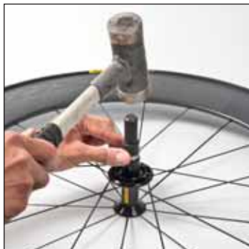
Montar el nuevo rodamiento del lado rueda libre con el útil 351 266 01
