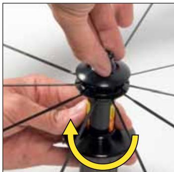
Vuelva a enroskar la tuerca de ajuste del buje para mantener en su sitio las cabezas de los radios.
