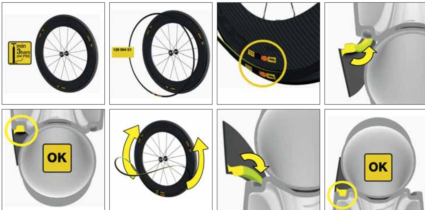
Repita la operación para el segundo perfil, e hinche el neumático a la presión deseada (entre 6 y 11 bar).
