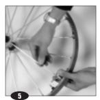
Puede ocurrir que en ausencia de los radios, las dos alas del buje hayan girado la una con respecto a la otra. Bajo el efecto de la tensión de los radios, ellas mismas se volverán a situar en su lugar correcto.
