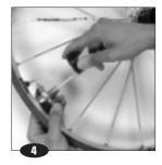
ATENCIÓN: la manipulación de la cabecilla del radio influye de forma significativa sobre la tensión del radio y con ello en el centrado de la rueda. En la fase final de tensión, 1/4 de vuelta a la cabecilla corresponde aproximadamente a 0,3 mm de desplazamiento lateral de la llanta.
