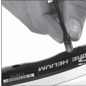
Enrosque 2 vueltas la cabecilla de este radio en el **1er agujero a la derecha del orificio de la válvula** (junto a los puntos de punzón).
