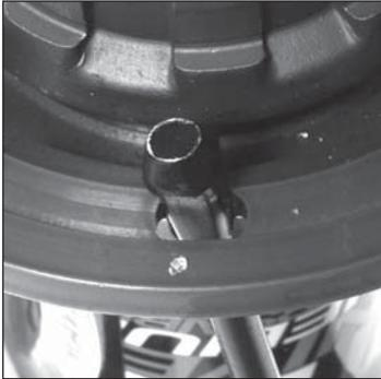
Introduzca un radio de 275 mm (324 179 01) en el alojamiento del buje del lado del piñón, por el interior del ala, **obligatoriamente en el que está marcado con un punto hecho con punzón.**
