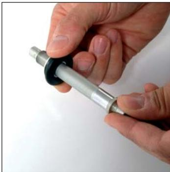
Si el guardapolvos del rodamiento necesita ser sustituido, deslícelo a lo largo del eje para quitarlo.
