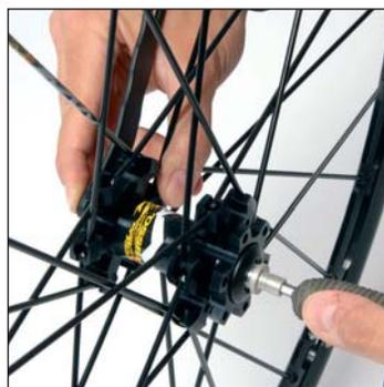
Introduzca la llave allen de 5 mm por el lado opuesto a la tuerca de ajuste, enrósquela hasta que haga tope y aflójela una vuelta.
