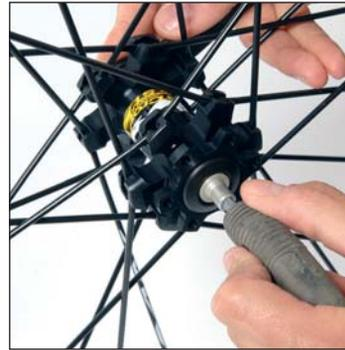
Introduzca en el eje la llave allen de 5 mm, por el lado opuesto a la tuerca de ajuste y aflójela.
