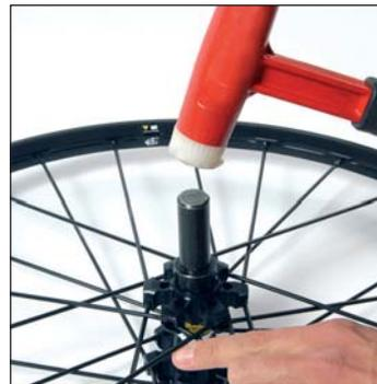
Monte los nuevos rodamientos mediante el útil de montaje M40120 o M40373.
