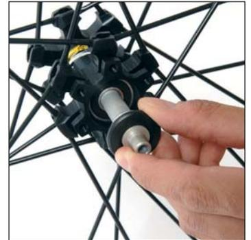
Desenrosque completamente la tuerca de ajuste y extraiga el eje del buje.
