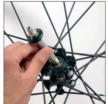
Vuelva a montar el guardapolvos del rodamiento en el eje y luego introduzca el eje en el buje por el lado del disco.
