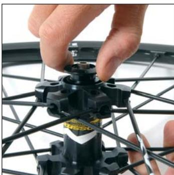
Enrosque a mano la tuerca de ajuste y sujétela mediante la llave de pitones M40123.
