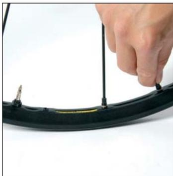
Dé la vuelta a la rueda. Enrosque un radio unas 2 vueltas en el tercer agujero a la derecha del de la válvula. Haga lo mismo con todos los radios no frenantes, en 1 de cada 4 agujeros de la llanta.
