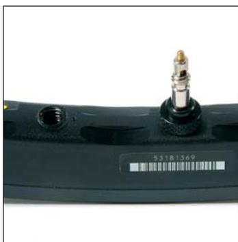
Con el agujero de la válvula junto a usted, sitúe la llanta de forma que la marca del puntero se encuentre a la izquierda del de la válvula.
