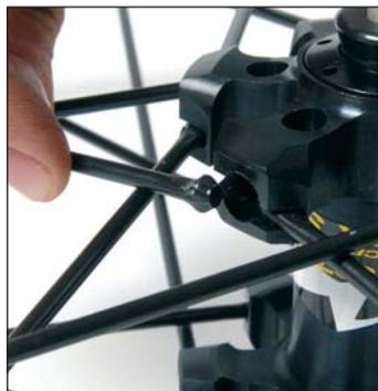
Introduzca las cabezas de estos radios en las ranuras del buje por el lado del disco: los radios no frenantes en las interiores, los radios frenantes en las exteriores.
