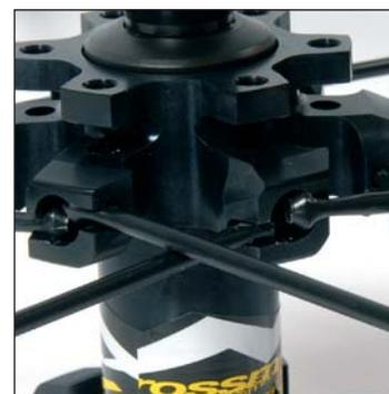
Introduzca las cabezas de estos radios en las ranuras del buje por el lado del disco: los radios no frenantes en las interiores, los radios frenantes en las exteriores.
