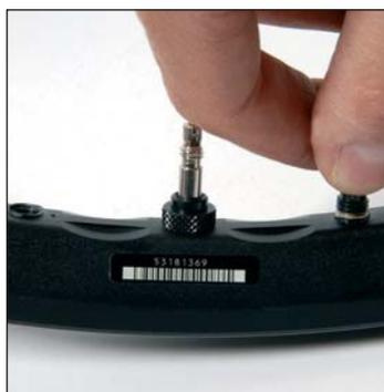
Enrosque un radio unas 2 vueltas en el primer agujero a la derecha del de la válvula. Haga lo mismo con todos los radios no frenantes, en 1 de cada 4 agujeros de la llanta.
