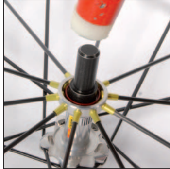
Montate i nuovi cuscinetti utilizzando l'estrattore di montaggio M40120.
