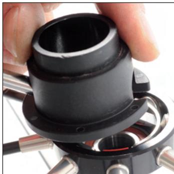
Inserite la punta del cacciavite attraverso l'apertura dello strumento per anello TraComp nella scanalatura dell'anello TraComp, esattamente tra 2 clips.
