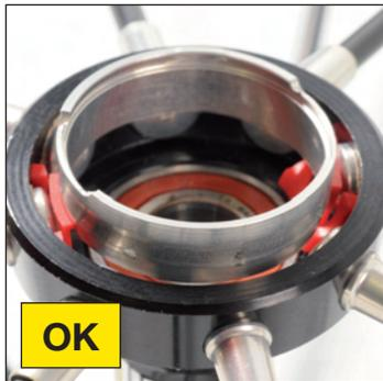
Presentate l'anello TraComp sulle teste dei raggi, con il lato conico verso il basso e la scanalatura interna verso l'alto, facendo attenzione a farlo scivolare tra ciascuna delle 2 clips.
