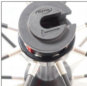
Posizionate lo strumento per anello TraComp 996 080 01 a contatto con l'anello, in modo che la rappresentazione del martello sia visibile sullo strumento.
