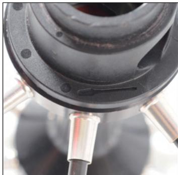
Posizionate lo strumento per anello TraComp 996 080 01 sul mozzo di modo che la rappresentazione del cacciavite sia visibile sullo strumento.
