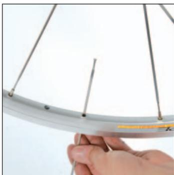
Passate infine un raggio, testa prima, nel primo foro a destra del foro valvola. Questi raggi sono trattori.
