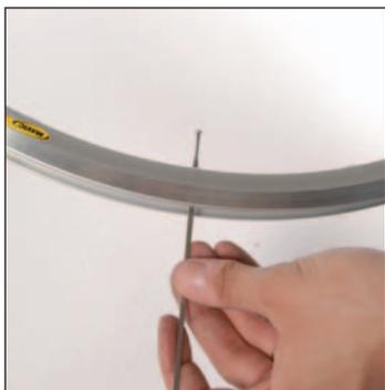
Con il foro valvola vicino a voi, fate passare un raggio, testa prima, nel primo foro a sinistra del foro valvola, poi continuate 1 raggio ogni 2.
