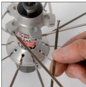
Presentate la testa di questo raggio sotto il 1° raggio non trattore incrociato, poi sopra il 2° raggio non trattore incrociato. Inserite la testa di questo raggio nella scanalatura dell'alloggiamento corrispondente.
