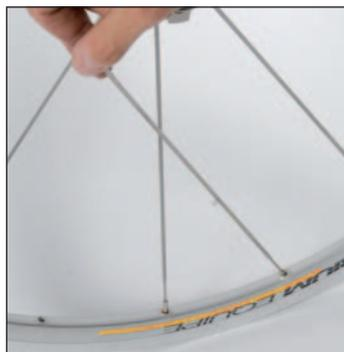
Passate ora un raggio, testa prima, nel terzo foro a destra del foro valvola, poi continuate 1 foro ogni 4.
