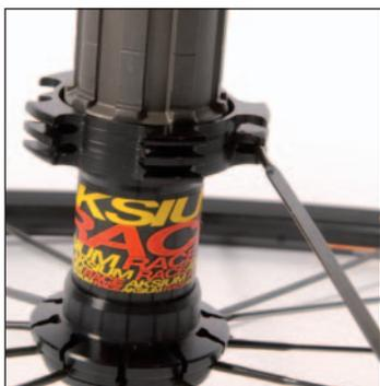
Il primo raggio a destra del foro valvola è non trattore: inseritelo in un alloggiamento interno del mozzo e fate lo stesso per 1 raggio ogni 4
