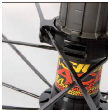
Il 3° raggio a destra del foro valvola è trattore: inseritelo in un alloggiamento esterno del mozzo e fate lo stesso per tutti i raggi restanti.
