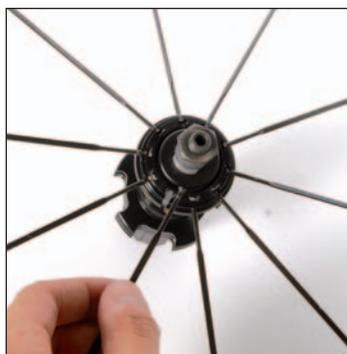
Inserite ogni testa di raggio negli alloggiamenti della flange del mozzo dal lato opposto alla ruota libera, dall'esterno della flange.
