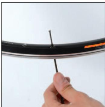
Con il foro valvola verso di voi, fate passare un raggio, testa prima, nel primo foro a destra del foro valvola, poi continuate 1 foro ogni 2.
