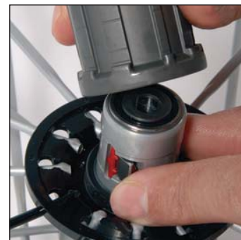
Reinserite la rondella distanziale sul cuscinetto del corpo del mozzo, abbassate i cricchetti e rimettete in posizione il corpo della ruota libera sul mozzo.
