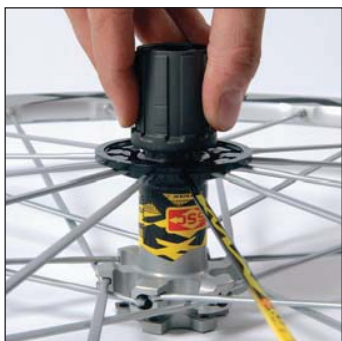
Rimuovere il corpo della ruota libera facendolo ruotare in senso antiorario.
