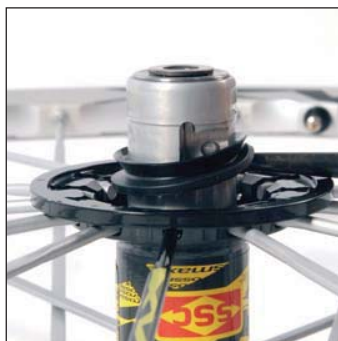
Rimuovere delicatamente la guarnizione a labbro utilizzando un utensile appuntito ma non tagliente.
