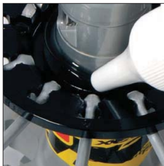
Lubrificare l'interno del corpo della ruota libera nella zona dentata in maniera tale da riempire da 2 a 3 scanalature del corpo della ruota libera. Depositare pure un goccia d'olio minerale Mavic M40122 sulla guarnizione a labbro.
