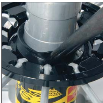
Riposizionate la guarnizione a labbro in battuta sul corpo del mozzo spingendola tra la base e il labbro utilizzando un utensile appuntito ma non tagliente.
