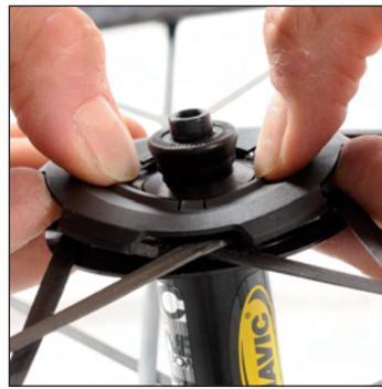
Agganciate i copri-mozzo curvando il loro diametro interno verso il basso, in modo da posizionare i gancetti di fissaggio uno alla volta. Verificate il corretto posizionamento dei riscontri del copri-mozzo sopra ciascuna placchetta.
