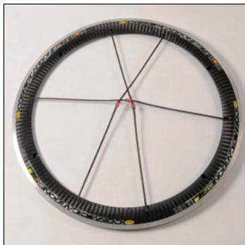
Montate il 3° raggio nel 9° foro a destra del foro valvola contando in senso anti-orario. La 2° estremità di questo raggio si posiziona nel 19° foro.
