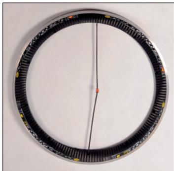
Con il foro valvola vicino a voi, avvitate un raggio nel primo foro a destra del foro valvola e la sua seconda estremità nell'11° foro, contando in senso orario.
