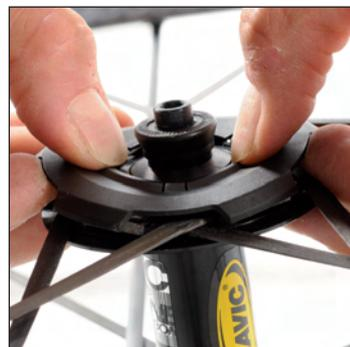
Agganciate i copri-mozzo curvando il loro diametro internoverso il basso, in modo da posizionare i gancetti di fissaggio uno alla volta. Verificate il corretto posizionamento dei riscontri dei copri-mozzo sopra ciascuna placchetta.
