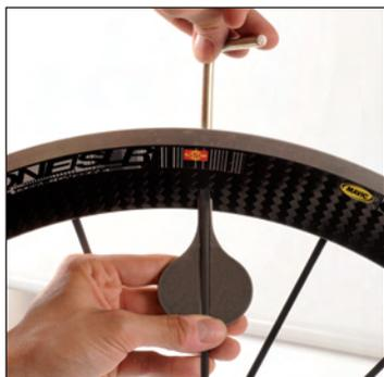
Effettuate la regolazione definitiva della ruota mantenendo le teste dei raggi all'interno della flangia in carbonio del cerchio con lo strumento per il trattenimento 101 295 01. **Questo strumento deve essere presentato dal lato dove c'è lo spazio maggiore e deve entrare senza sforzo.**
