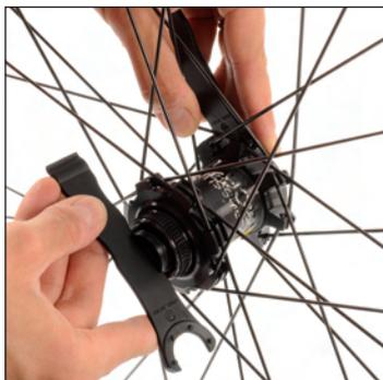
Mantenete la chiave M40123 in posizione e svitate l'asse dal lato disco con le dita (Crossmax SX) o con il manico di una seconda chiave M40123 inserita nelle aperture dell'asse (Crossline).
