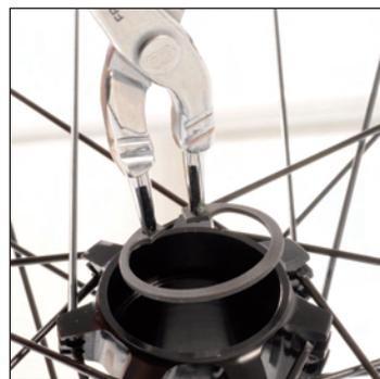
Rimontate le circlips dal lato opposto al disco con la pinza per circlips.
