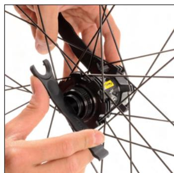
Riavvitate la ghiera di regolazione con la chiave a piolini, trattenendo l'asse manualmente (Crossmax SX) o con il manico di una seconda chiave M40123 inserita nelle aperture dell'asse (Crossline) fino al contatto del cuscinetto e svitate di un ¼ di giro.
