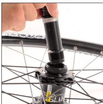
*Introduisez l'axe dans le moyeu par le côté disque. Pour la Crossmax SX 09, prenez soin de vérifier la présence de la rondelle de calage.*
