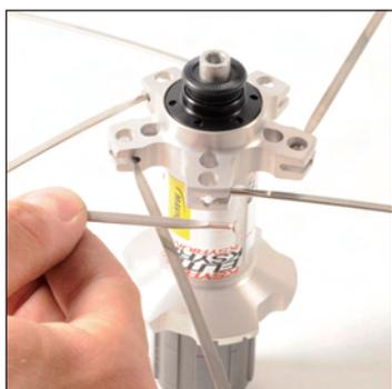
Presentate la testa di un raggio trattore passando sotto il cerchio, sotto il 1° raggio non trattore e poi sopra il 2° raggio non trattore. Inserite la testa di questo raggio nell'alloggiamento del mozzo corrispondente.
