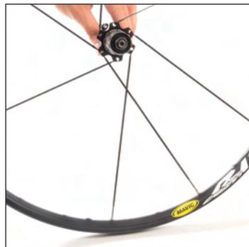
Con il foro valvola vicino a voi, inserite questo raggio nel 3° foro a destra del foro valvola e avvitate il suo nipple di 2 giri. Fate lo stesso per i 6 raggi trattori lato ruota libera.
