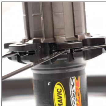
Inserite la testa di un raggio in un alloggiamento del mozzo in modo che questo raggio sia trattore.
