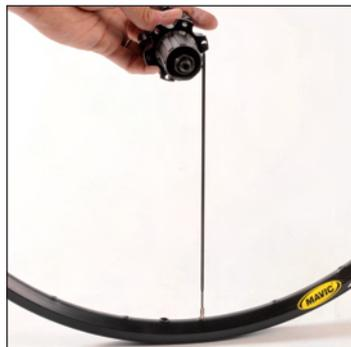
Con il foro valvola vicino a voi, inserite questo raggio nel 1° foro a destra del foro valvola e avvitate il suo nipple di 2 giri. Fate lo stesso per i 6 raggi non trattori lato ruota libera.
