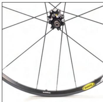
Con il foro valvola vicino a voi, inserite questo raggio nel 1° foro a destra del foro valvola e avvitate il suo nipple di 2 giri. Fate lo stesso per i 6 raggi trattori lato opposto alla ruota libera.
