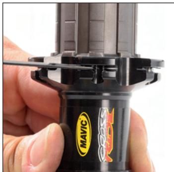
Inserite la testa di un raggio in un alloggiamento del mozzo in modo che questo raggio sia non trattore.
