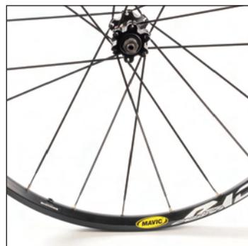
Con il foro valvola vicino a voi, inserite questo raggio nel 3° foro a destra del foro valvola e avvitate il suo nipple di 2 giri. Fate lo stesso per i 6 raggi non trattori lato opposto alla ruota libera.
