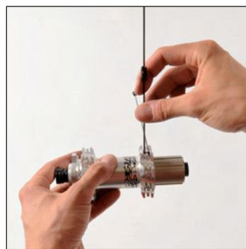
Ricominciate l'operazione con un nuovo raggio nello stesso alloggiamento, ma questa volta dalla parte **interna** dell'alloggiamento.
