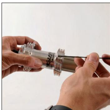
Presentate la testa di un raggio su di un alloggiamento orientandolo parallelamente all'asse del mozzo, dall'esterno della ruota.
