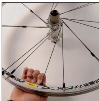
Avvitate, fino a quando non sia frenato, il nipple di un raggio **non trattore** (parte **interna** dell'alloggiamento a destra dell'asse del mozzo) nel 1° foro a destra del foro valvola.
