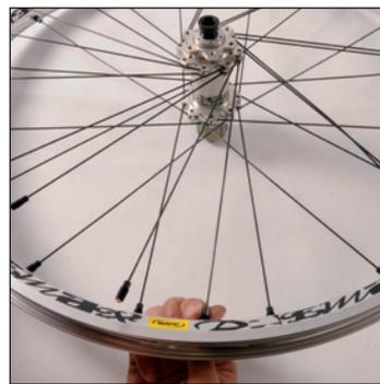
Avvitate, fino a quando non sia frenato, il nipple di un raggio **trattore** (parte **interna** dell'alloggiamento a destra dell'asse del mozzo) nel 1° foro a destra del foro valvola.
