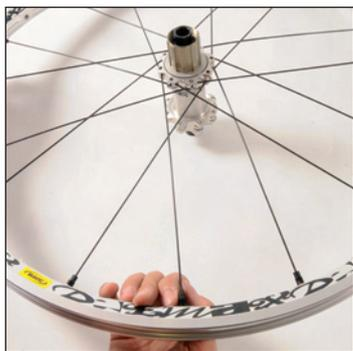
Avvitate, fino a quando non sia frenato, il nipple di un raggio **trattore** (parte **esterna** dell'alloggiamento a sinistra dell'asse del mozzo) nel 3° foro a destra del foro valvola.
