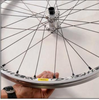
Avvitare, fino a quando non sia frenato, il nipple di un raggio **frenatore** (parte **esterna** dell'alloggiamento a destra dell'asse del mozzo) nel 1° foro a destra del foro valvola.
