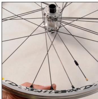
Avvitare, fino a quando non sia frenato, il nippile di un raggio **non frenatore** (parte **interna** dell'alloggiamento a sinistra dell'asse del mozzo) nel 3° foro a destra del foro valvola.
