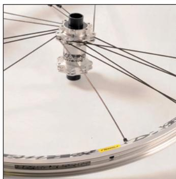
Avvitare, fino a quando non sia frenato, il nippile di un raggio **non frenatore** (parte **interna** dell'alloggiamento a destra dell'asse del mozzo) nel 1° foro a destra del foro valvola.
