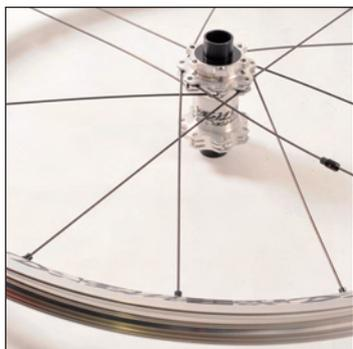
Avvitare, fino a quando non sia frenato, il nippile di un raggio **frenatore** (parte **esterna** dell'alloggiamento a sinistra dell'asse del mozzo) nel 3° foro a destra del foro valvola. Fate lo stesso per tutti i raggi **frenatori** posizionati sulle parti **esterne** degli alloggiamenti, 1 foro su 4 nel cerchio.
