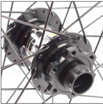
Sulla ruota anteriore, sui due lati, le pieghe dei raggi frenatori devono essere orientate verso l'esterno delle flange del mozzo.
