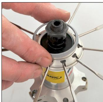
Agganciate il copri-mozzo sulla flangia del mozzo (vi permetterà di mantenere i raggi in posizione durante i successivi passaggi)
