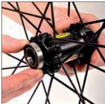
Inserite il nuovo cuscinetto del lato disco dal lato opposto al disco e spingetelo in posizione con l'estrattore di montaggio 996 887 01
