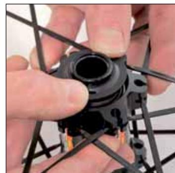
Rimontate il para-polvere spingendolo parallelamente all'asse
