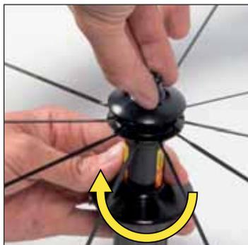
Riavvitate la ghiera di regolazione del mozzo per mantenere in posizione le teste dei raggi.
