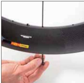
Con il foro valvola vicino a voi, inserite un raggio nel 1° foro a destra del foro valvola, poi fate lo stesso per tutti i raggi, 1 foro su 2.
