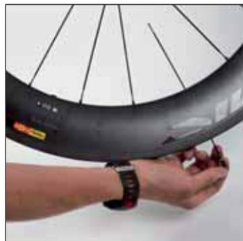
Con il foro valvola vicino a voi, inserite un raggio nel 3° foro a destra del foro valvola.
