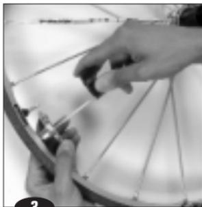
**ATTENZIONE : la manipolazione della bussola dei raggi influisce in maniera significativa sulla tensione del raggio e di conseguenza sulla regolazione della ruota. In fase finale di tensionamento 1/4 di giro a livello della bussola corrisponde a circa 0,3 mm di variazione laterale del cerchio.**
