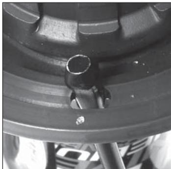
Inserite un raggio 275 mm (324 179 01) nella foratura del mozzo, lato ruota libera, dall'interno della flangia. **Scegliere obbligatoriamente la foratura contrassegnata da una punzonatura.**
