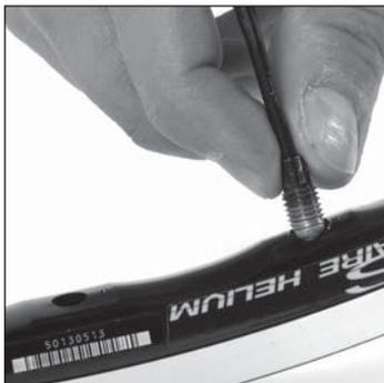
Avvitare di 2 giri il nipple di questo raggio nel **1° foro a destra del foro valvola** (foro in prossimità della punzonatura).
