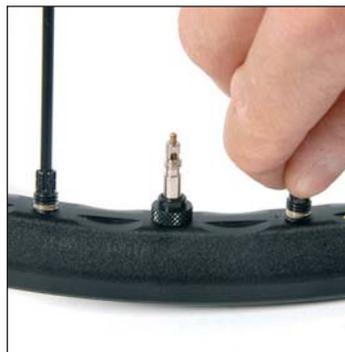
Avvitate infine un raggio per due giri nel primo foro a destra del foro valvola. Fate lo stesso per tutti i raggi di frenata, 1 foro ogni 4 nel cerchio.
