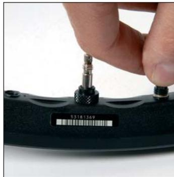
Avvitate il raggio per due giri nel primo foro a destra del foro valvola. Fate lo stesso con tutti i raggi non frenanti, 1 foro ogni 4 nel cerchio.
