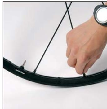
Avvitate ora un raggio per 2 giri nel terzo foro a destra del foro valvola. Fate lo stesso per tutti i raggi di frenata, 1 foro ogni 4 nel cerchio.
